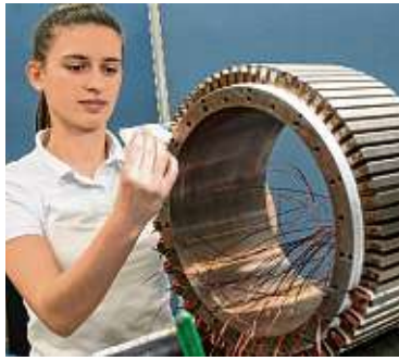
Majnovic kümmert sich um das Isoliersystem für den Stator eines Direktantriebs. BILDER: JENS-ULRICH KOCH/DPA
